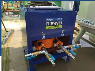
回収ポンプユニット本体
