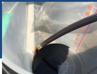
地下水表面からの油分回収状況
